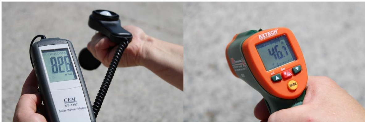
Kuva 7. Jalkakäytävällä auringonpaisteessa auringonsäteily on 826 W.m-2 ja pintalämpötila 46,7 °C.
