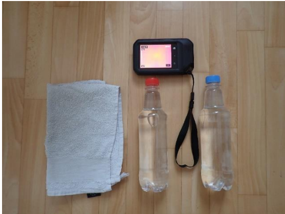
Kuva 12. Kokeessa tarvittavat välineet: kaksi PET-muovipulloa, jotka on täytetty saman lämpöisellä vedellä, lämpökamera ja pyyhe.
