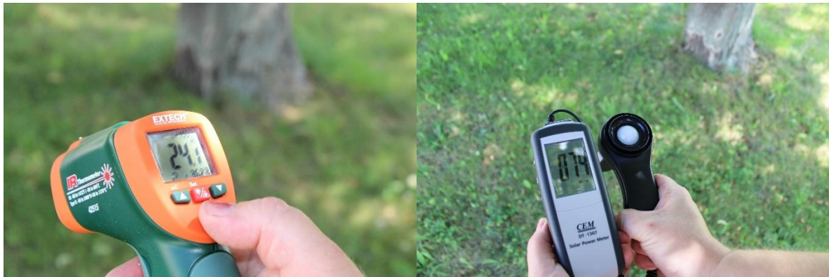
Kuva 6. Puun varjossa voidaan mitata lämpötila 24,1 °C sekä auringonsäteily 74 W.m -2 .
